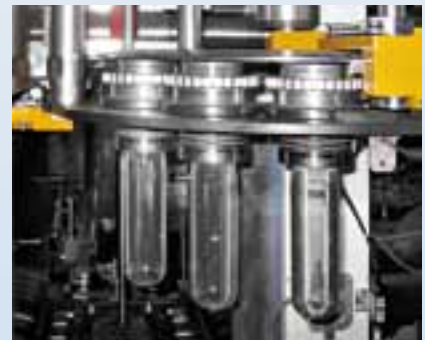
Protección del cuello durante el transporte de la preforma dentro la sopladora
